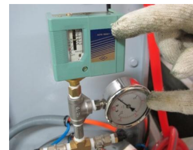
設置過濾袋系統自動清除與檢知棉絮
